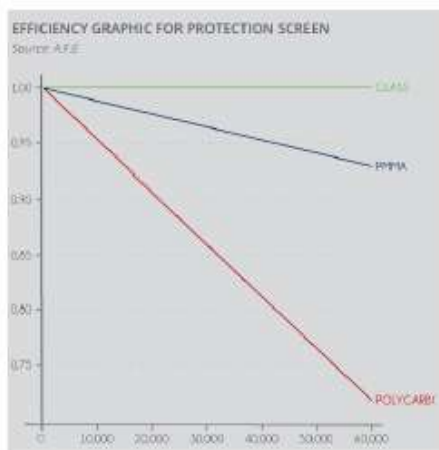
Figura 2 - Pérdida de la eficiencia del material óptico expuesto a la fuente de luz
